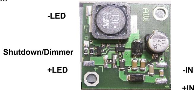
**Achtung:** Minuspol vom Eingang und Minuspol vom Ausgang (an LED) **NIEMALS** miteinander verbinden! Einbau von Schaltern nur in der Zuleitung der Eingangsseite, **NIE** auf der Ausgangsseite.
