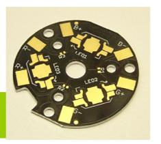
Bauen Sie Ihre eigene 3-fach LED-Powerleuchte! Platine auf Kühlkörpern u.Ä. empfehlen wir COOLTAPE Wärmeleitklebeband und Pads.
