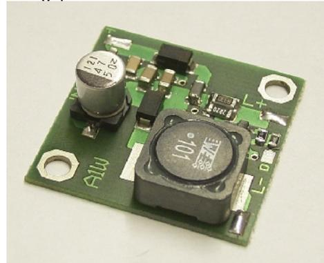
Das Modul kann bis zu 14 Hochleistungs-LEDs in weiß, blau oder grün, bzw. bis zu 20 Hochleistungs-Leuchtdioden in rot, amber, orange oder gelb je nach Eingagsspannung mit konstantem Strom versorgen. Für optimale Lebensdauer von Hochleistungs-LEDs, typ. 50.000 Stunden.
