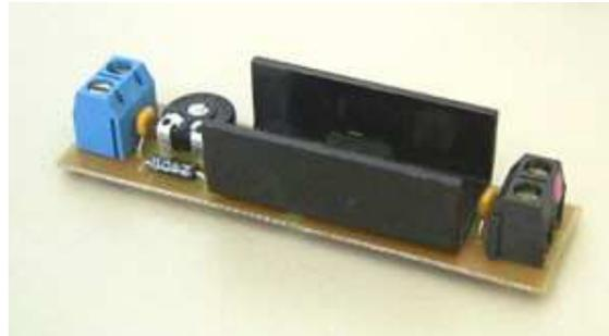
Spannungsregler 1,2 bis 25 Volt einstellbar, stabilisiert, bis 1 A Ausgangsstrom, lötfrei
