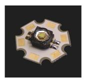
Zur Montage der Platine auf Kühlkörpern u.Ä. empfehlen wir COOLTAPE Wärmeleitklebeband und Pads.
